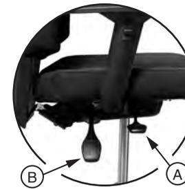
Synchro-tilter Mechanism / Siège inclinable-synchro
